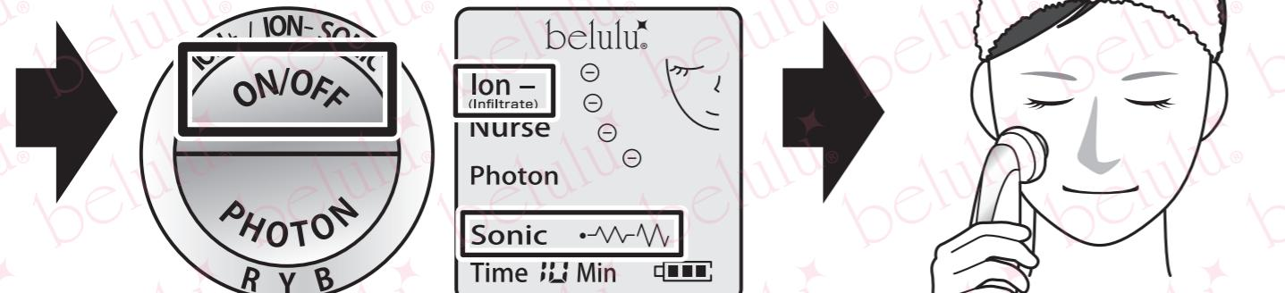
③ ON/OFFボタンでマイナスイオン+超音波モードに設定します。超音波の強さもお選びください。
